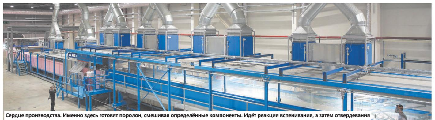
Сердце производства. Именно здесь готовят поролон, смешивая определённые компоненты. Идёт реакция вспенивания, а затем отвердевания
